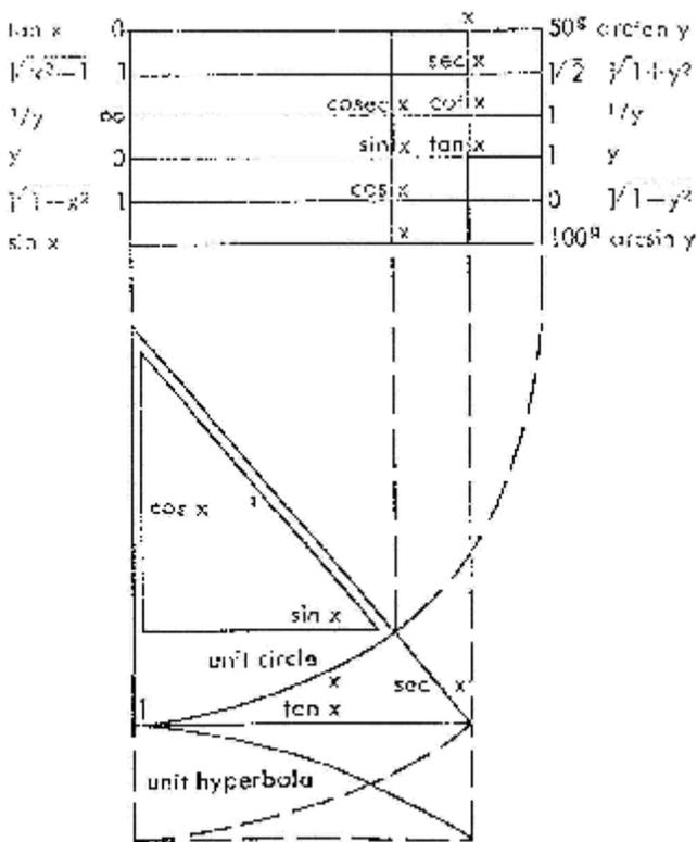
**Triángulos rectángulos en el círculo unidad y en la hipérbola unidad con ángulos iguales. Las escalas del diagrama no son logarítmicas.**
